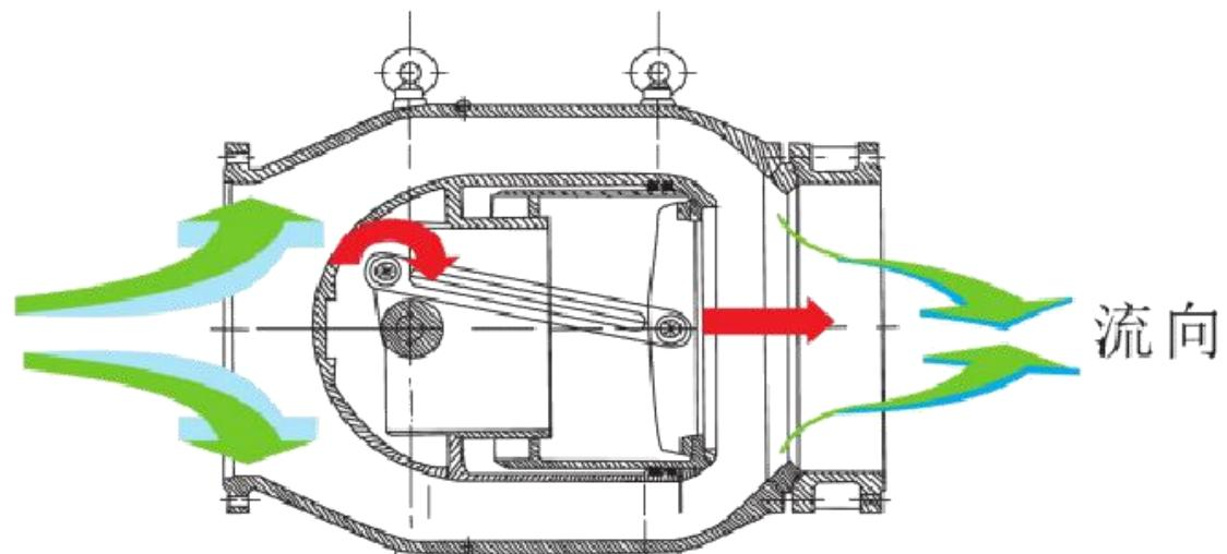
气泡在鼠笼中央对撞破裂而消能(减压) 通常用于高压差
